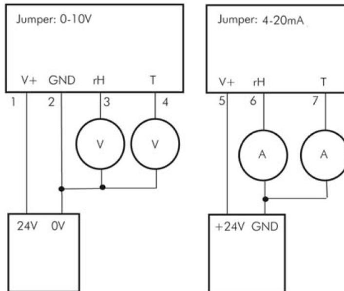
**ACHTUNG:** Bei Strombetrieb müssen immer beide Ausgänge angeschlossen werden.
